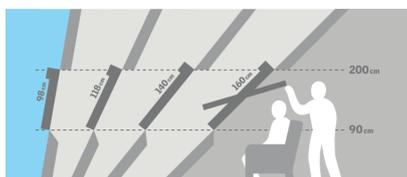
Las ventanas giratorias permiten la colocación de muebles debajo de la ventana sin obstruir su funcionamiento.
